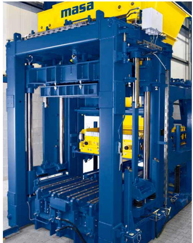
Станция прессования для машины серии "XL" в комплекте с вибростолом
