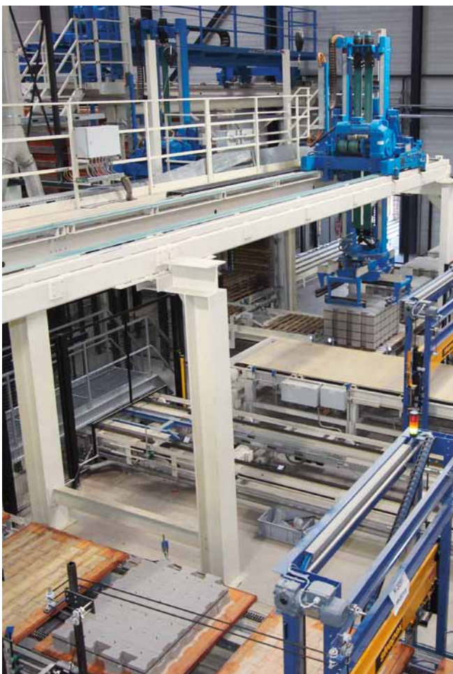
Устройства перегруппировки изделий и пакетирования фирмы «Маза»
