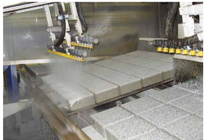
Установка промывки поверхности изделий с тремя станциями
