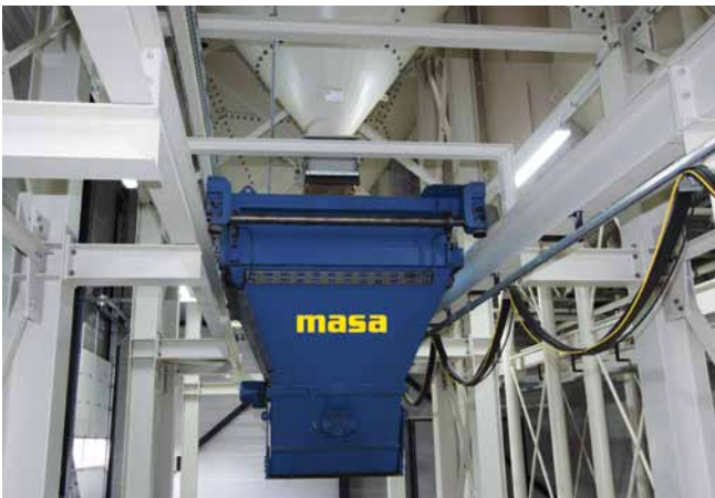
Точное дозирование при помощи передвижной загрузочной вагонетки
