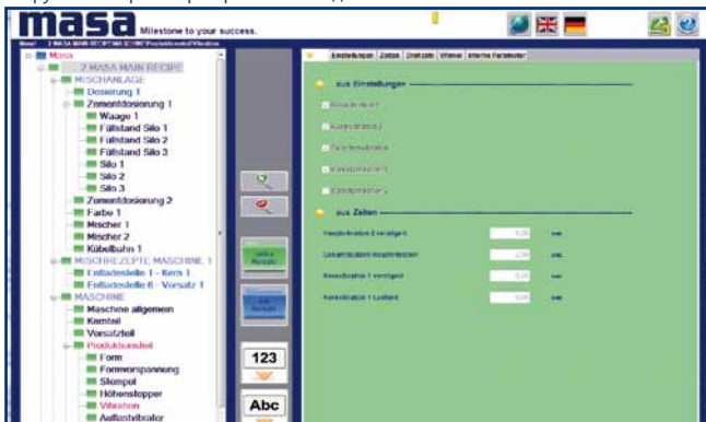
Система автоматизации производства (FAST) фирмы «Маза»: управление рецептами
