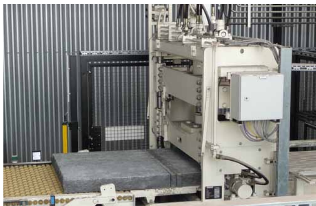
Сплиттер фирмы «Маза» для финишной обработки поверхности изделий
