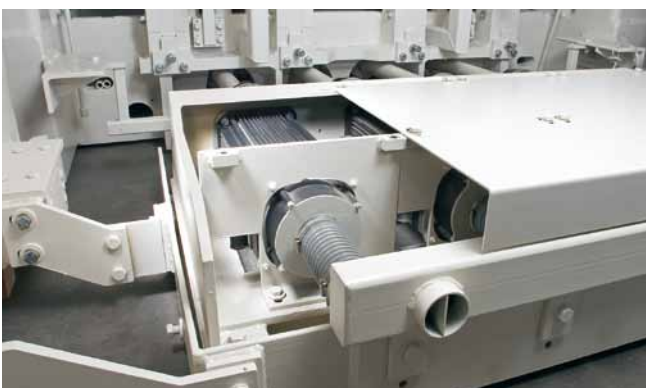
Система вибрации с сервоприводом
