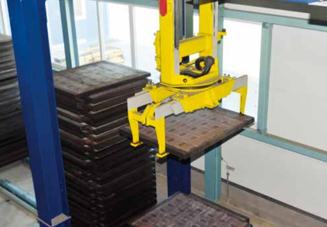
Автоматический накопитель производственных поддонов фирмы «Маза»
