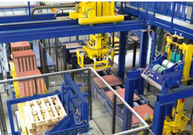
Накопитель транспортных поддонов и линия пакетирования
