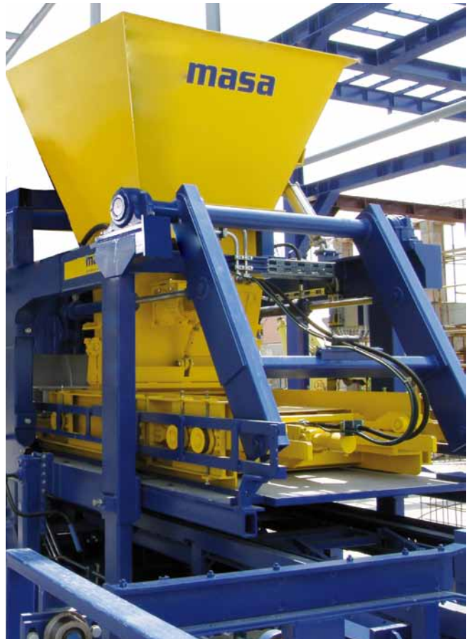
Камнеформовочная машина компактной серии "L"
